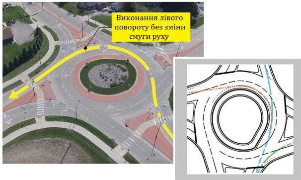
Рис. 2. ПРК зі спіралеподібним розміщенням кільцевої проїзної частини [4]
