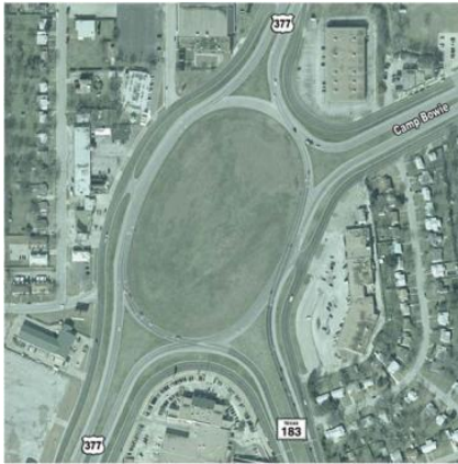
Рис. 1. Примикання/перехрещення в одному рівні кільцевого типу великого діаметра ( rotary ), згідно з [4]
