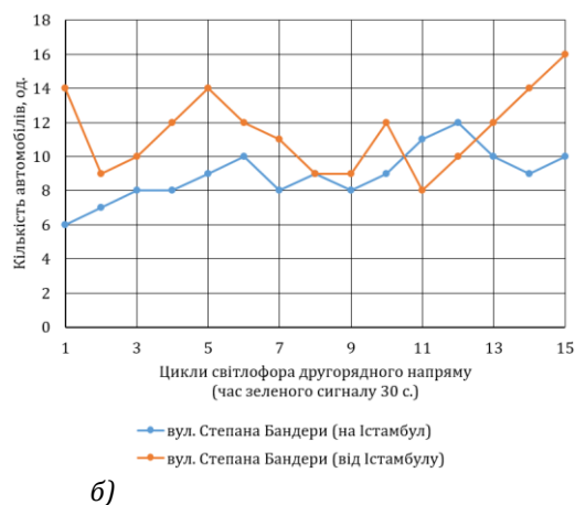
Рис. 4. Кількість транспортних засобів, які проїжджають перехрестя за один цикл дозвільного сигналу світлофора для головного (а) та другорядного (б) напрямків
