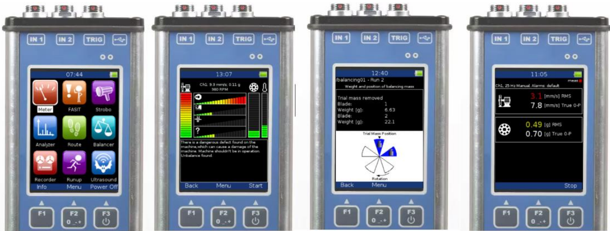
Рис. 2. Портативний віброаналізатор VA3 Pro (компанія Adash)
