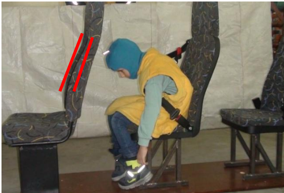
Рис. 6. Триточковий ремінь безпеки з дитячою утримуючою системою «Напрямна лямка»
