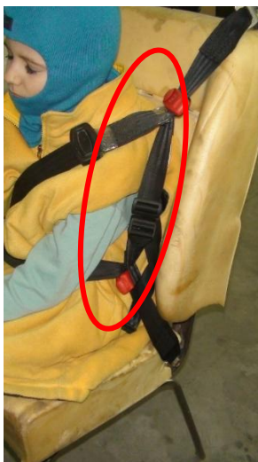
Рис. 11. Розташування напременної лямки з триточковим ременем безпеки
