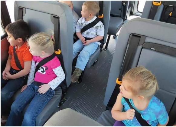
Рис. 10. Застосування напременної лямки в автобусах для перевезення дітей
