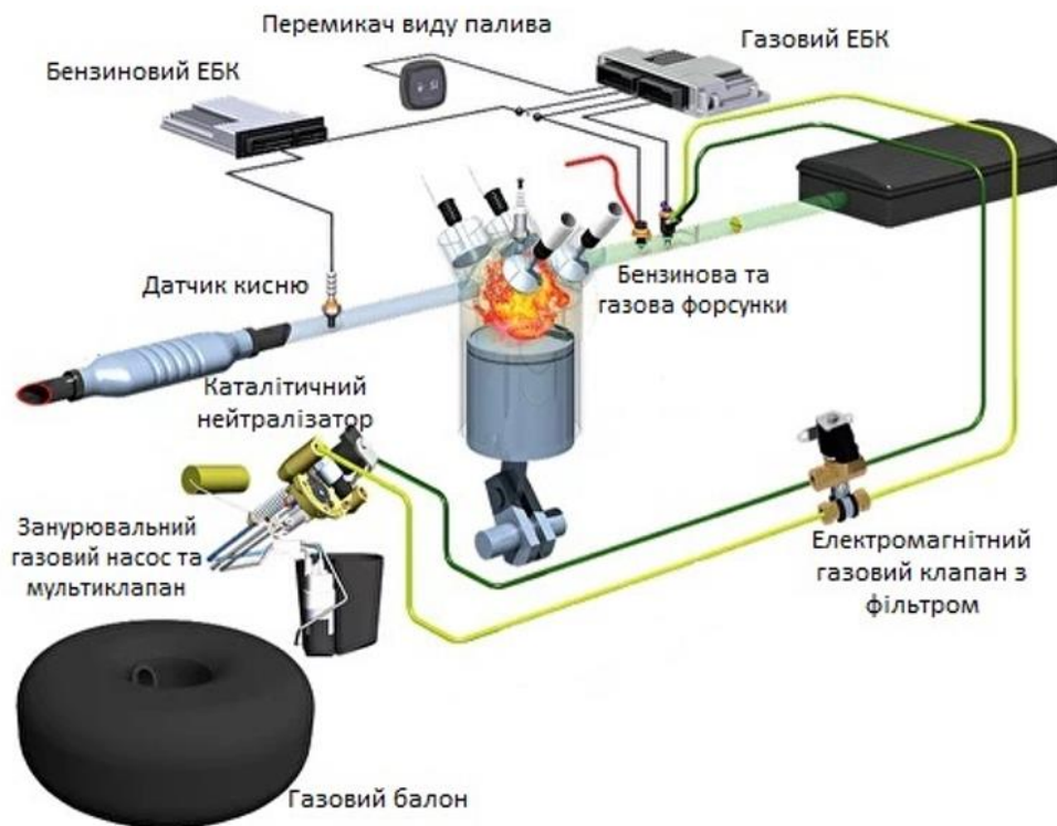
Рис. 5. Схема система ГБО Liquid Si компанії Vialle Autogas Systems B.V.
