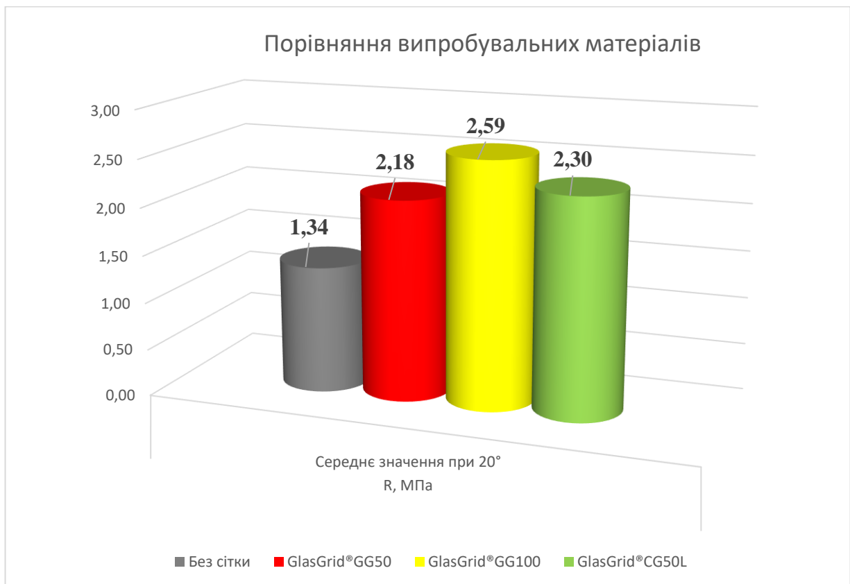
Рис. 11. Діаграма порівняння результатів випробувань зразків-балок із визначення границі міцності на розтяг при вигині
