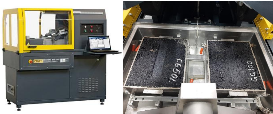
Рис. 3. Установка для випробування двошарових асфальтобетонних зразків-плит на колієстійкість та розміщення зразків-плит у формах
