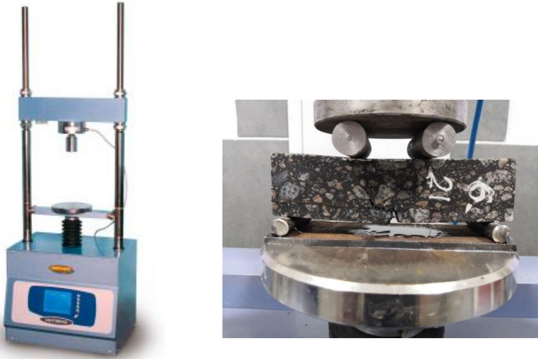
Рис. 10. Універсальна машина (прес) для випробувань на стиск до 50 кН UNITRONIC фірми Matest (Італія) та зразок-балка з навантажувальними і опорними стрижнями
