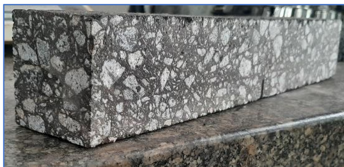
Рис. 7. Зразок-балка для проведення випробування втомну довговічність при чотириточковому згині
