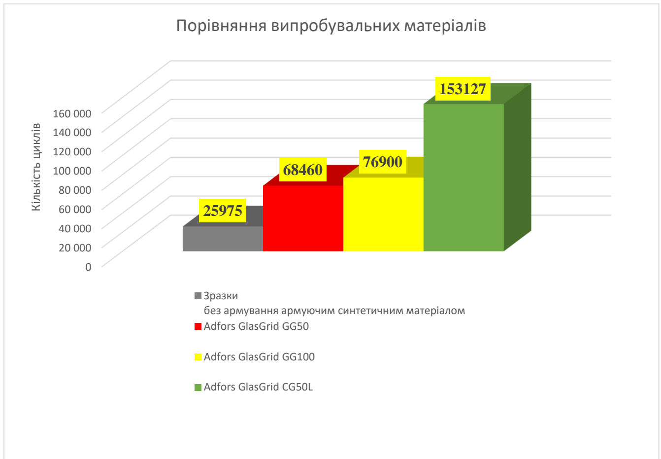
Рис. 9. Діаграма результатів випробування на втомну довговічність при чотириточковому згині для визначення втомної довговічності асфальтобетонного покриття, армованого армуючими синтетичними матеріалами Adfors GlasGrid® у порівнянні з неармованим асфальтобетонним покриттям
