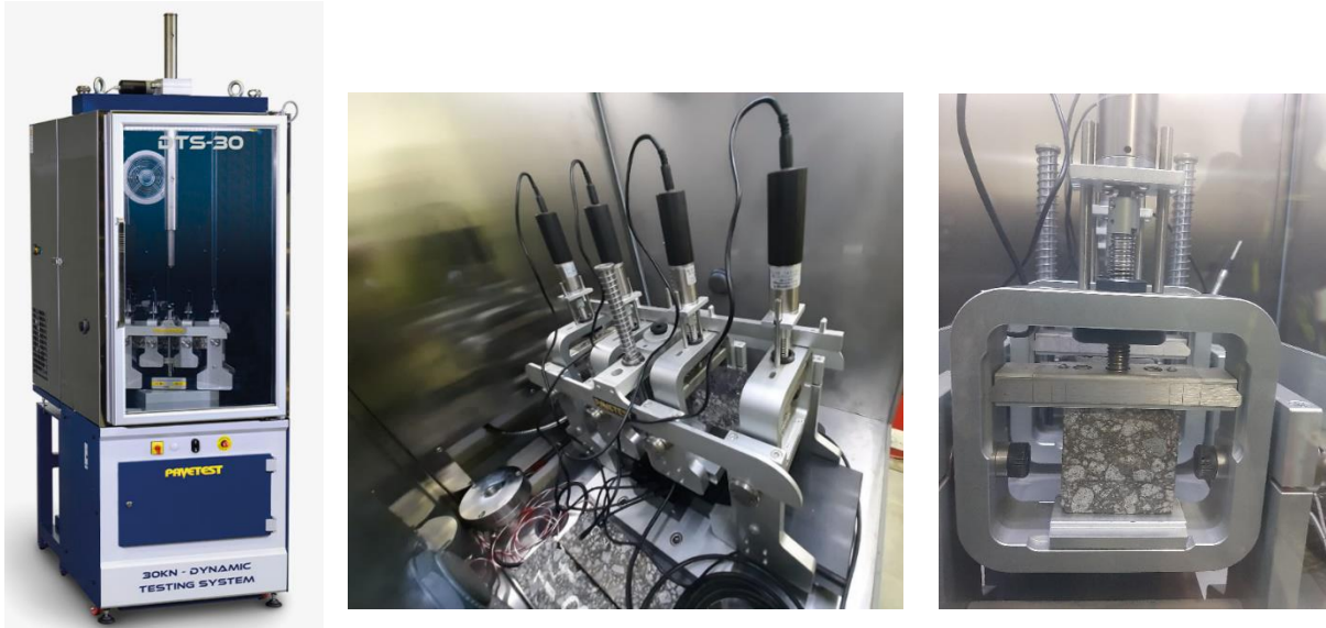
Рис. 8. Пристрій для випробування призматичних зразків-балок на втомну довговічність при чотириточковому згині та розміщення зразка-балки у пристрої
