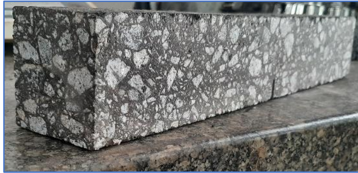
Рис. 7. Зразок-балка для проведення випробування втомну довговічність при чотириточковому згині
