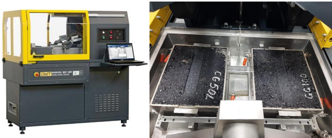
Рис. 3. Установка для випробування двошарових асфальтобетонних зразків-плит на колієстійкість та розміщення зразків-плит у формах
