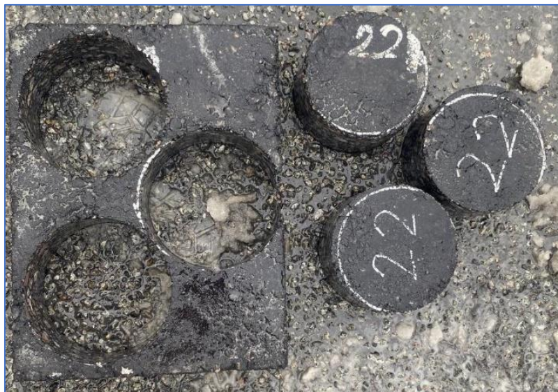
Рис. 5. Випилювання кернів для випробування зі зразків-плит
