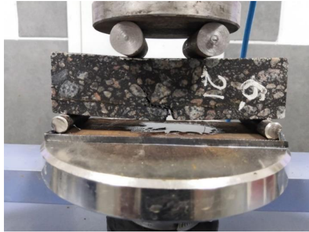
Рис. 10. Універсальна машина (прес) для випробувань на стиск до 50 кН UNITRONIC фірми Matest (Італія) та зразок-балка з навантажувальними і опорними стрижнями
