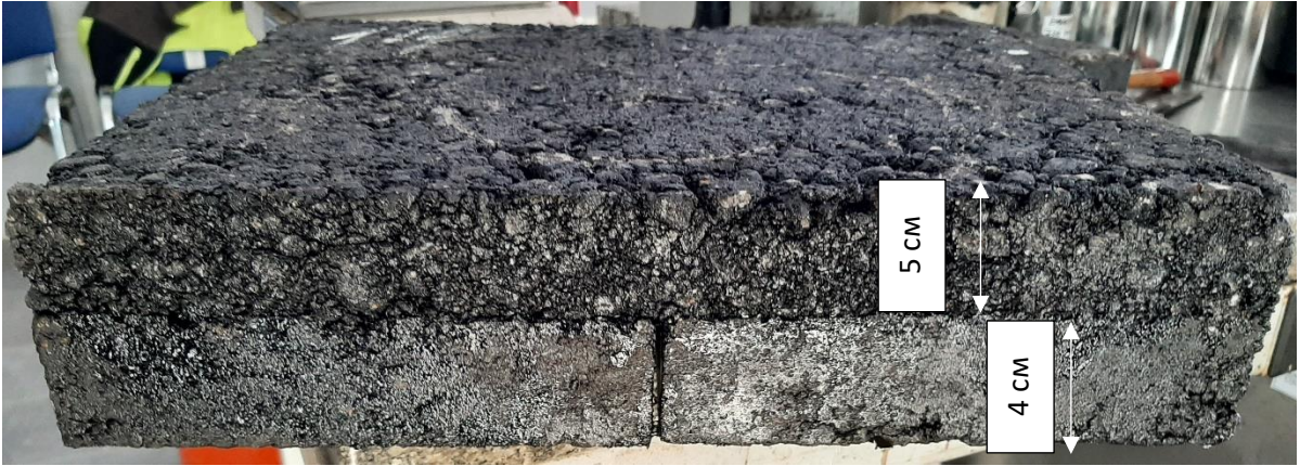
Рис. 2. Зразок-плита для випробування на визначення глибини колії
