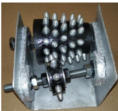
Рис. 3. Прототип зубчастого варіатора (діюча модель)
