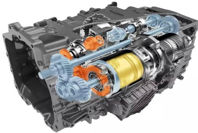
Рис. 11. Варіаторна трансмісія для тракторів фірми ZF із гідростатичним варіатором
