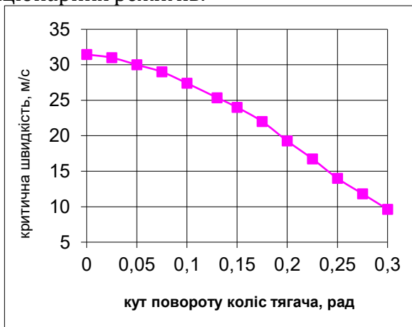
Рис. 2. Залежність критичної швидкості автопоїзда від кута повороту керованих коліс автомобіля
