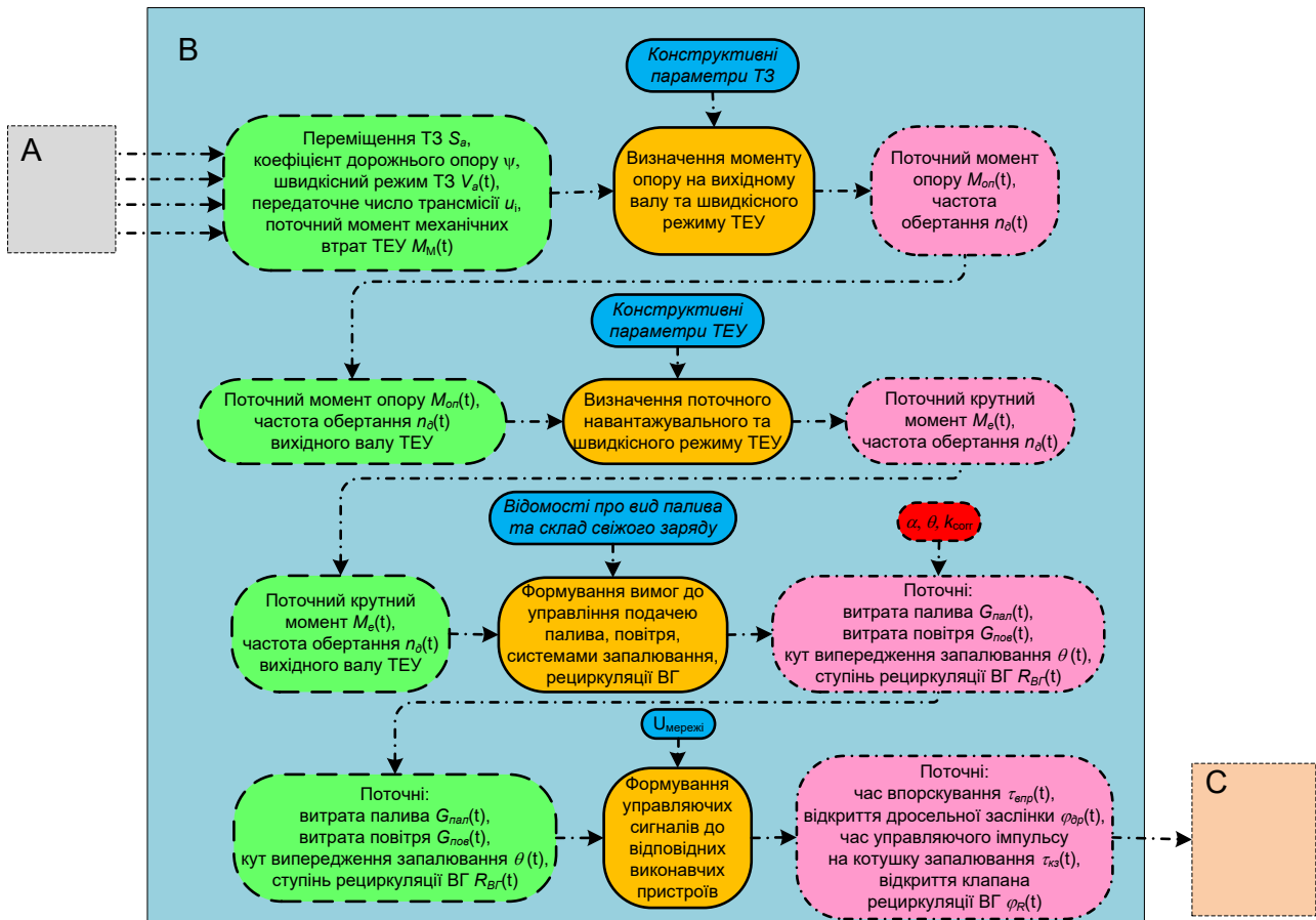
Рис. 4. Деталізована структура математичної підсистеми системи «ТЕУ-ІСУ»
