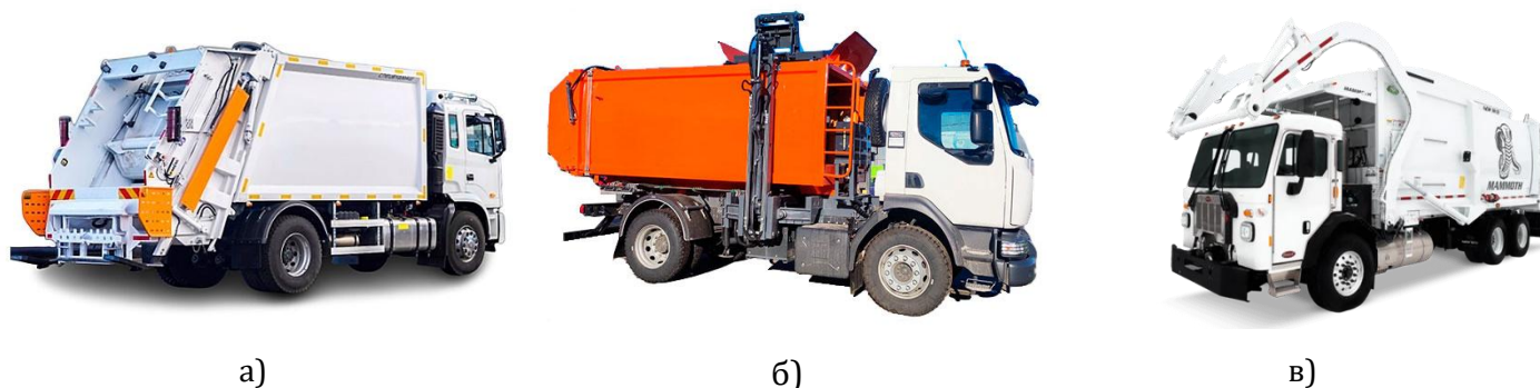
Рис. 1. Смітєвози з різним типом завантаження: а – з тильним завантаженням; б – з боковим завантаженням; в – з фронтальним завантаженням [7 – 9]
