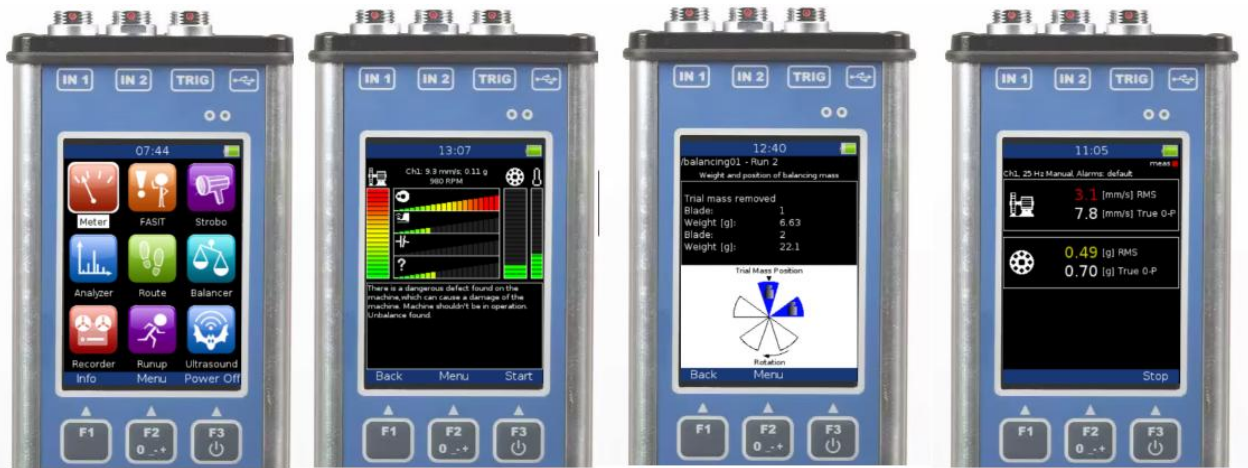
Рис. 2. Портативний віброаналізатор VA3 Pro (компанія Adash)
