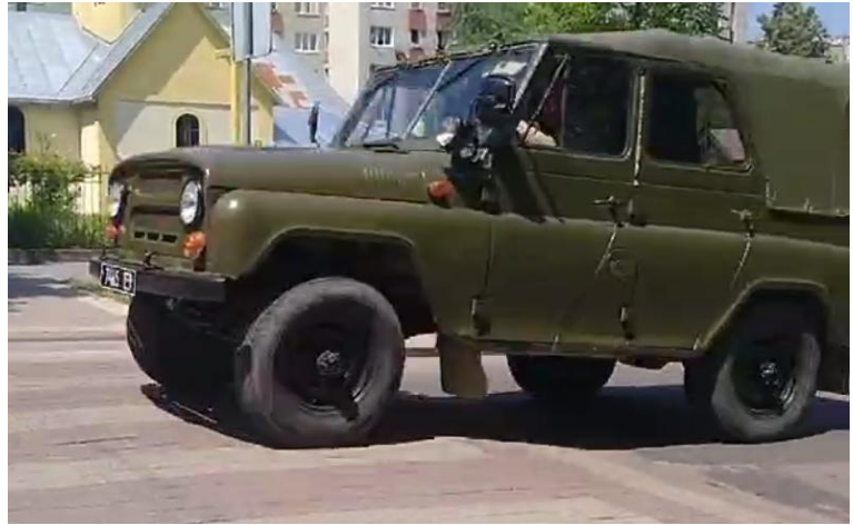
Рис. 2. Автомобіль УАЗ під час проїзду підвищеного пішохідного переходу (оцінка граничної швидкості для «пробою» підвіски)
