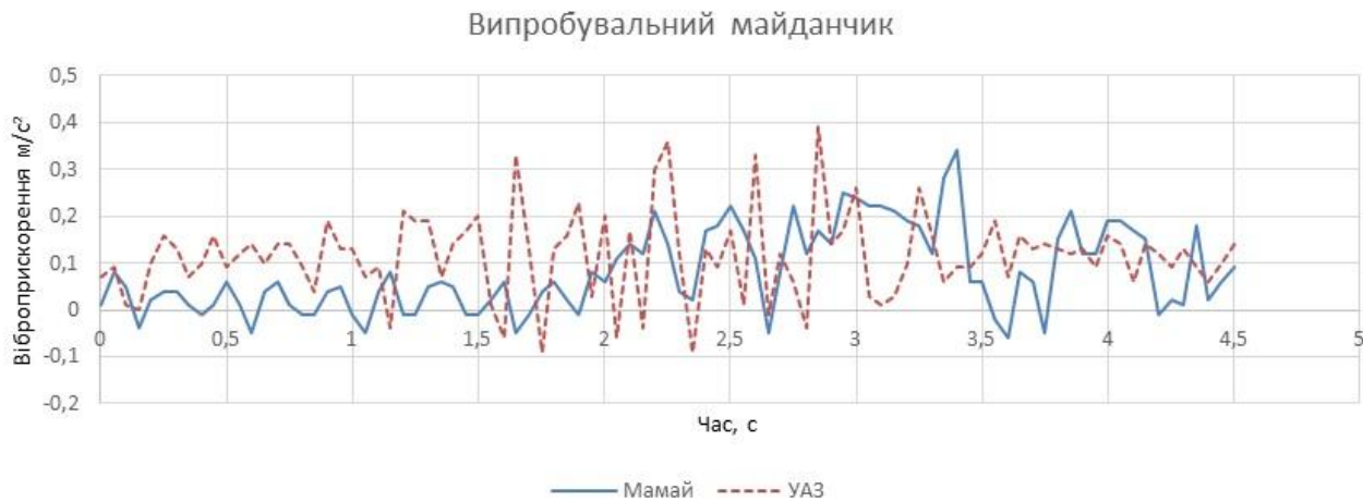
Рис. 3. Типові віброколивні навантаження на робочому місці водія під час проїздки випробувальної ділянки зі швидкістю 30 км/год
