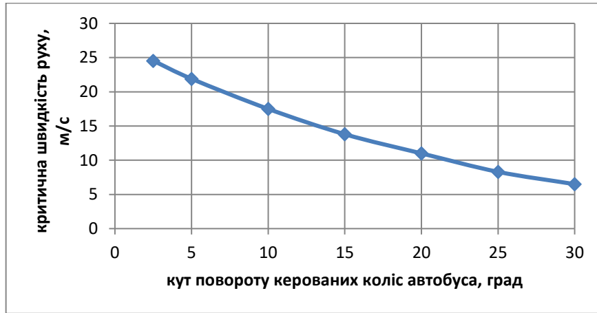
Рис. 2. Залежність критичної швидкості щодо керованості від кута повороту керованих коліс автобуса
