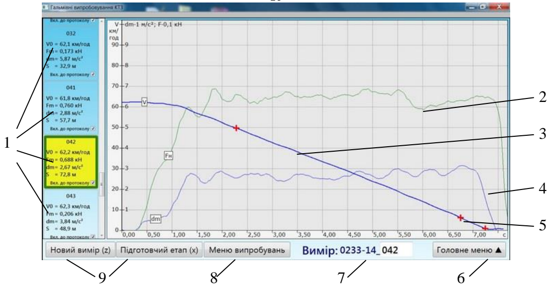
Рис. 6. Результати випробувань робочої гальмівної системи КТЗ: 1 – кнопки з результатами проведених вимірів (після натискання на екрані ПК з'являються відповідні графіки, а кнопка змінює свій колір на жовтий); 2 – зусилля на гальмівній педалі; 3 – швидкість; 4 – сповільнення; 5 – мітки, що вказують інтервал, на якому здійснюється обчислення параметрів гальмування; 6 – кнопка повернення до головного меню програми; 7 – номер поточного виміру; 8 – кнопка переходу до меню випробувань; 9 – кнопки керування випробуванням.
