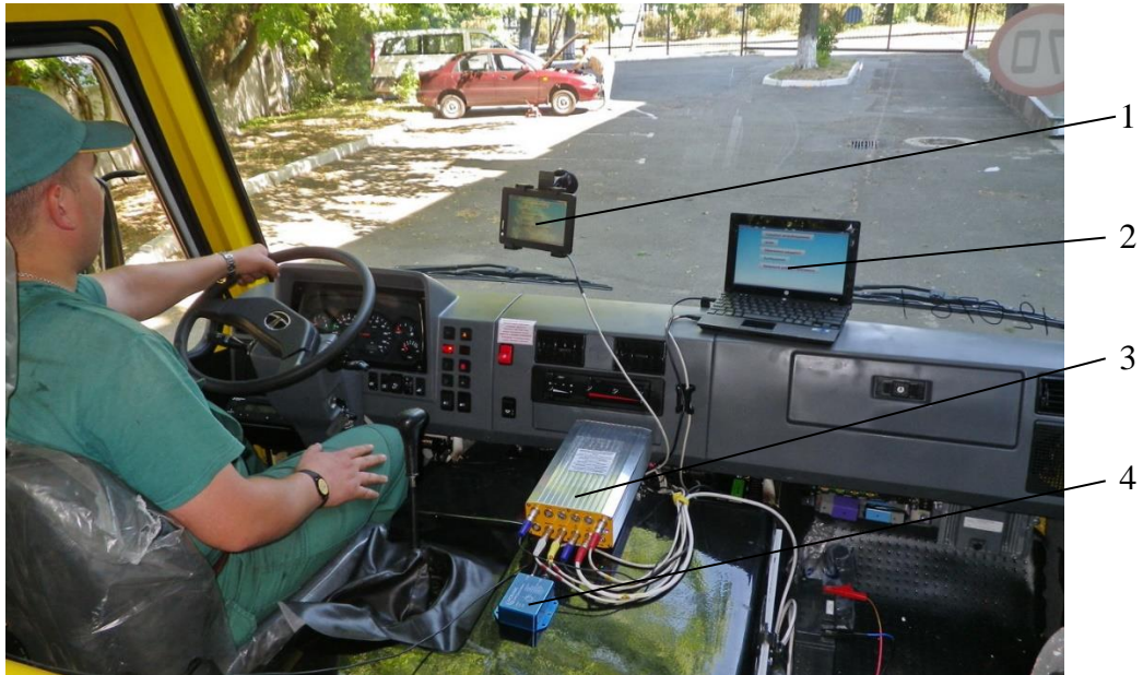
Рис. 4. Приклад встановлення комплексу на КТЗ: 1 – додатковий монітор; 2 – ноутбук; 3 – електронний блок; 4 – датчик шляху
