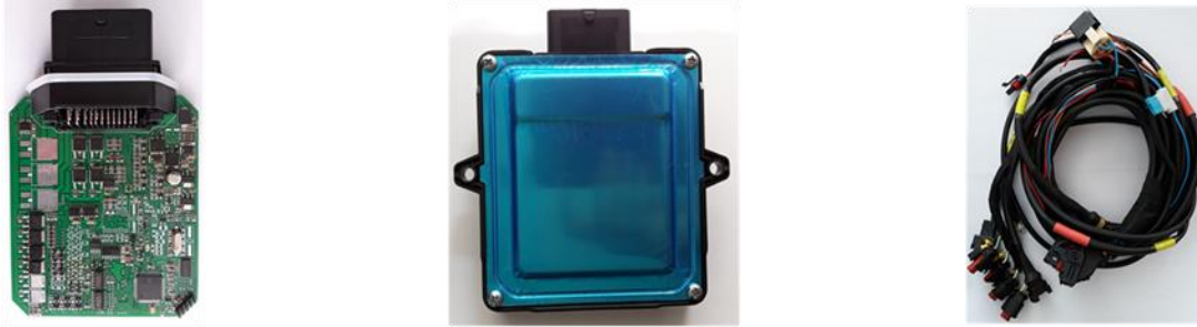
Рис. 2. Багатофункціональний мікропроцесорний ЕБУ Avenir Gaz 37 «В»: а – плата ЕБУ Avenir Gaz 37 «В» в зборі; б – зовнішній вигляд ЕБУ; в – джгути проводів з'єднання ЕБУ з датчиками і пристроями
