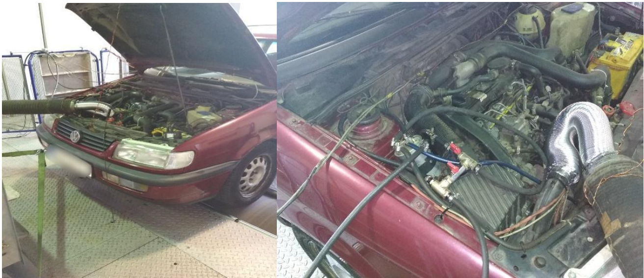
Рис. 1. Система живлення багатопаливного двигуна встановлена на автомобіль Volkswagen Passat B4
