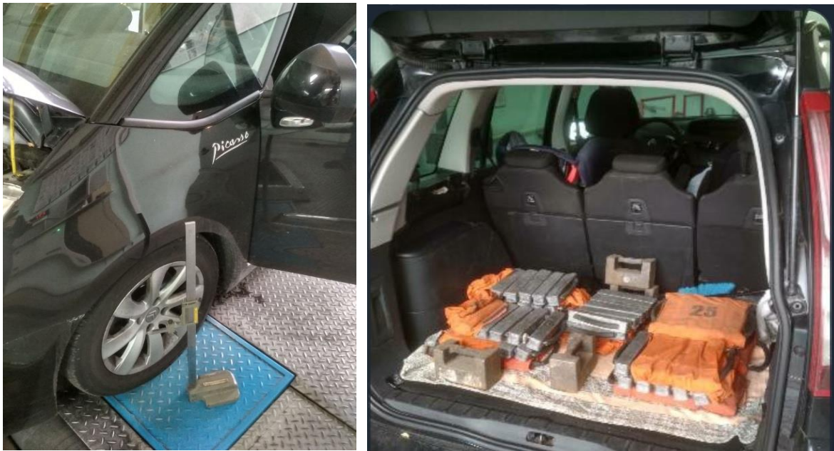
Рис. 2. Експериментальне визначення параметрів підвіски
