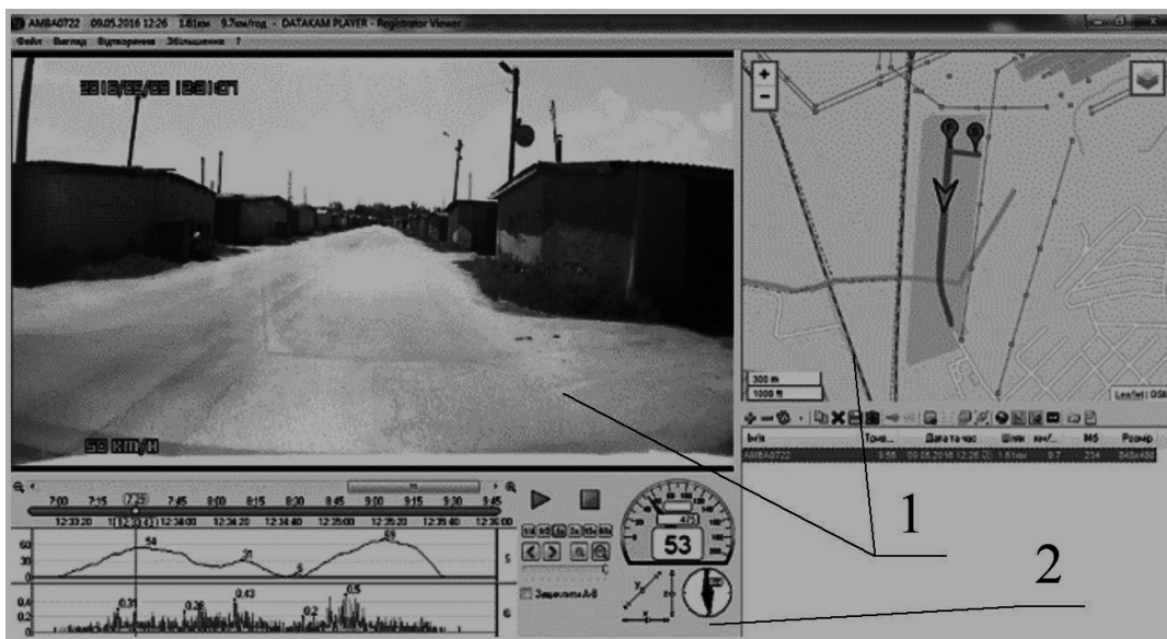
Рис. 3. Приклад реєстрації швидкостей руху та миттєвої витрати палива ДВЗ автомобіля в часі в процесі налагодження програмного комплексу RegistratorViewer
