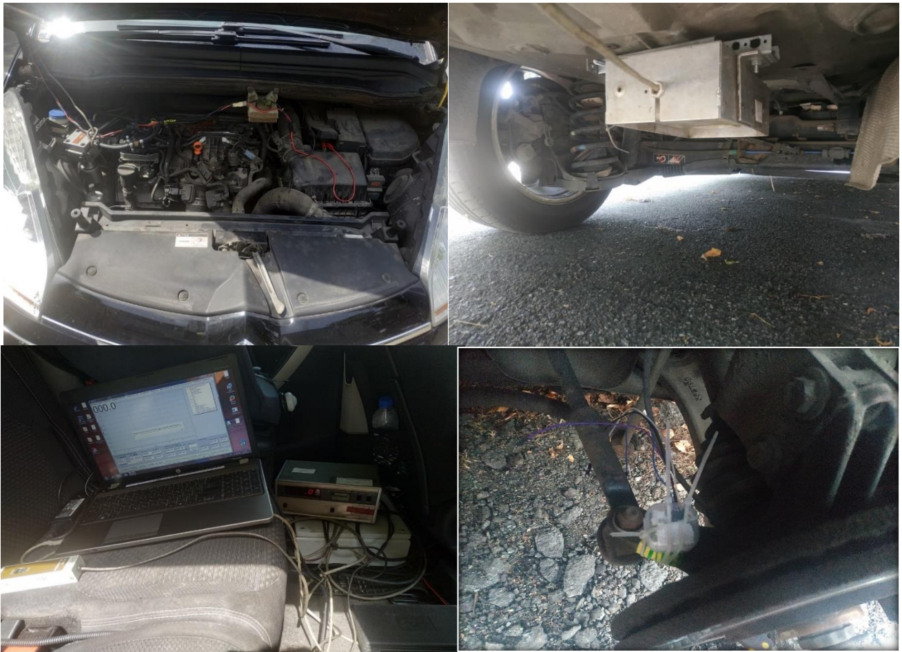
Рис. 3. Встановлений на автомобілі розроблений вимірювальний комплекс
