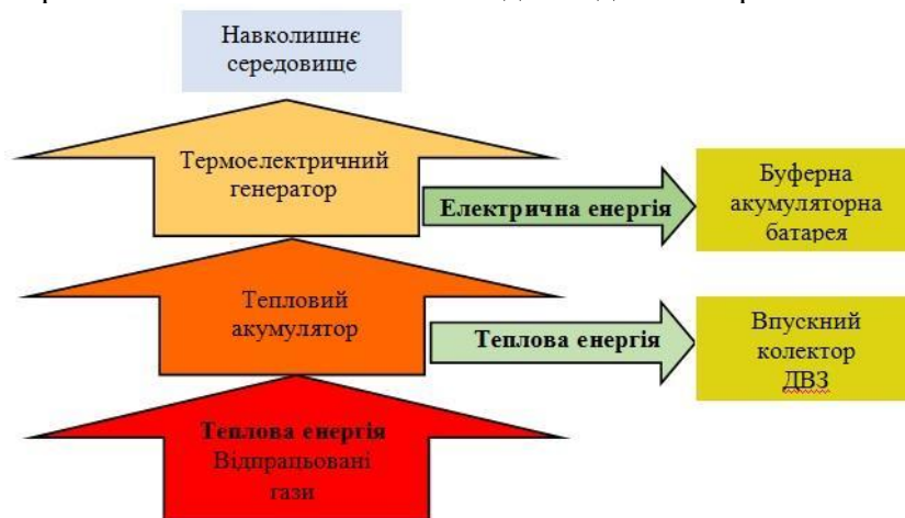
Рис. 2. Схема потоків енергій в системі комплексної енергоефективної утилізації частини теплової енергії відпрацьованих газів ДВЗ
