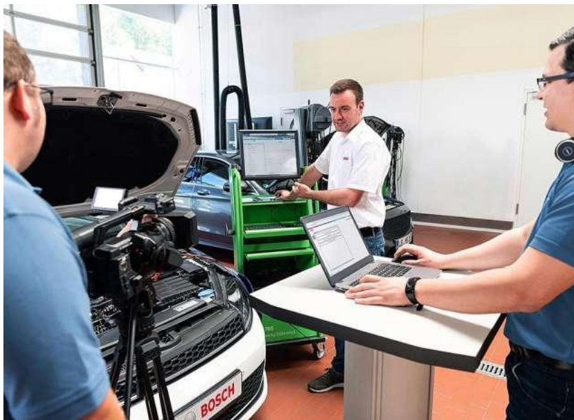
Рис. 1. Підключення до автомобіля оператора-діагнosta через мережу Інтернет за допомогою комунікаційного засобу RDS 500 фірми BOSCH
