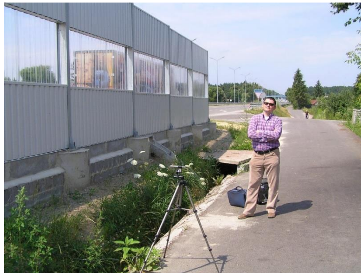
Рис. 4. До експериментального визначення акустичної ефективності екранів
