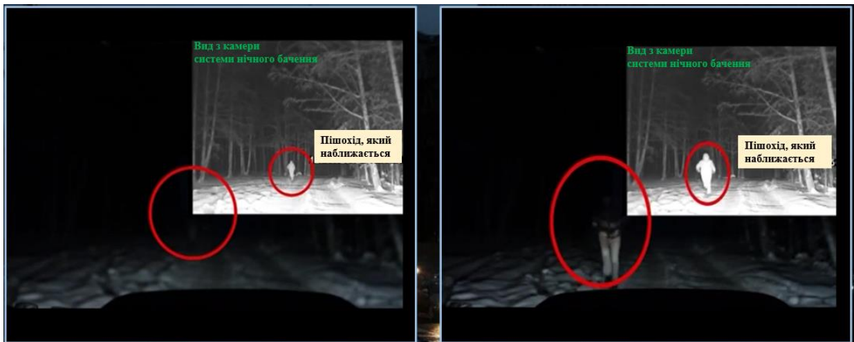
Рис. 2. Приклад роботи системи нічного бачення автомобіля
