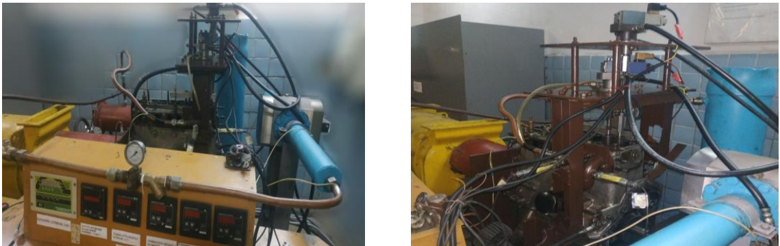
Рис. 1. Експериментальний стенд для випробувань ПД з електрогідроприводом клапанного механізму
