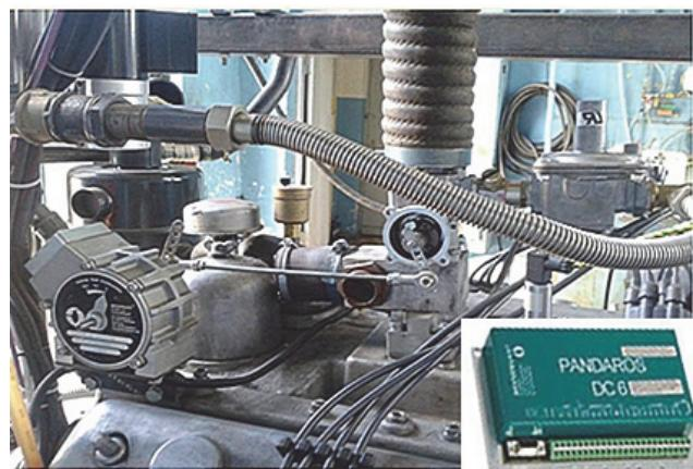
Рис. 1. Фото системи дозування газового палива з мікропроцесорним блоком управління
