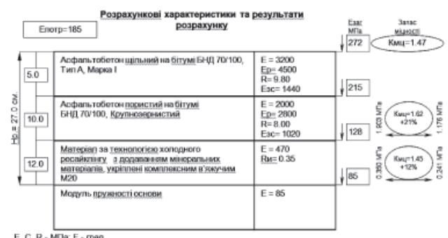
Рис. 3. Результати розрахунку конструкції дорожнього одягу варіанту 1
