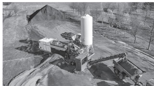
Рис. 1. Виготовлення суміші за технологією холодного ресайклінгу в установці KMA 240 [1]
