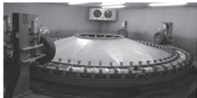
Рис. 2. Стенд для випробування на зношення
