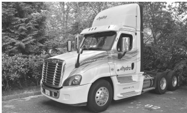
*Рис. 4. Сідельний тягач, переобладнаний компанією Hydra Energy для роботи за газодизельним циклом на стисненому "біоводні" (Канада, 2021 р.).*
