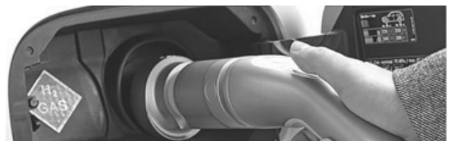
Рис. 3. Зовнішній вигляд пристрою для заправки КТЗ стисненим воднем
